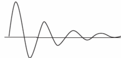
DECAIMIENTO PRONUNCIADO DE LA CONTRIBUCIÓN DE UN MOTOR DE INDUCCIÓN
